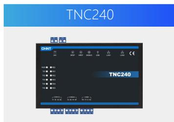
多功能网络控制器支持以太网、RS485、RS232等多种通讯接口，并支持多种标准通讯协议，可实现BACnet MSTP/IP、Modbus RTU/TCP、MQTT等行业内主流协议的相互转化，可用于能源物联网、楼宇自控、智能照明、能耗采集等系统。网络控制器内嵌web编程配置软件，方便用户调试和管理，设备支持连接外网，可使设备连接云服务，实现远程访问设备，依托云服务器可实现数据的存储、分析及共享等功能。
